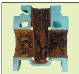
激しく腐食した鋳鉄バルブの内部
