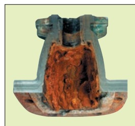
激しく腐食した鋳鉄バルブの内部
