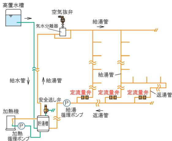
中央給湯設備の循環湯量を一定にし、均一に循環することで、お湯の滞留、湯温の低下を防止します。
