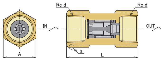
注: 本体一次側には、流れ方向識別用として、溝加工を施しています。
